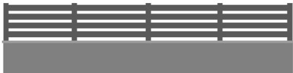
Mur bahut enduit surmonté de lames (PVC, alu, acier, bois etc...)
